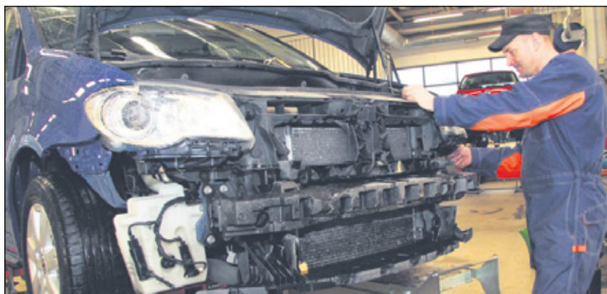
Autopeltiseppä Jari Eronen kokoaa auton etuosaa osana suurehkoa vauriokorjausta.
