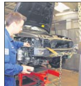
Mikael Kettunen kiinnittämässä Volvoa korinoikaisupenkkiin.
