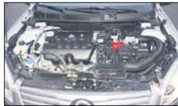
Moottorina koeajetussa Nissan Qashqai+2 4x4:ssä on 2-litrainen bensiinikone. Se tuottaa 104 kW:n tehon ja 196 Nm:n väännön – riittävästi kuutosvaihteellekin.
