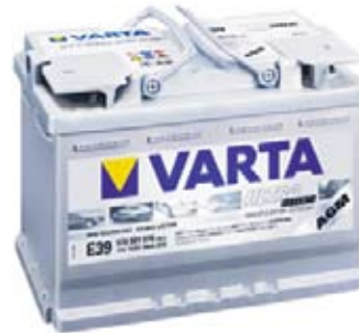
Lyijyakkujen viimeisintä tuotekehitystä edustaa AGM-akku, jossa elektroyttimeste on imeytetty lasikuitukankaaseen. Tämä sallii entistä suurempia hetkellisiä käyttö- ja varausvirtoja ja pidentää akun käyttöikää.
