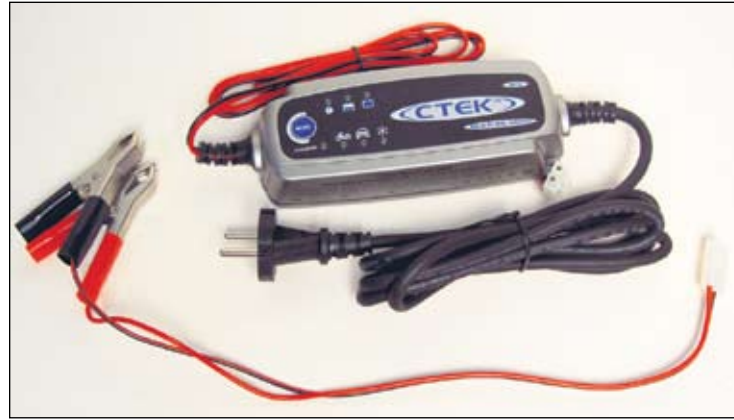
Elektroninen akkulaturi säätelee toimintoja akun varaustilan mukaan ja voidaan asentaa vaikka jatkuvaan ylläpitokäyttöön.
