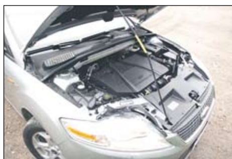
Koeajauton 2,0-litrainen Duratec-bensiinimoottori kehittää 107 kW:n tehon ja vääntöä 190 Nm.
