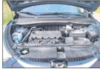
Koeajoautossa on 2-litrainen bensiinimoottori, joka tuottaa 120 kW:n tehon ja 194 Nm:n väännön. Moottorin jatkeena on 5-vaihteinen manuaalilaatikko.
