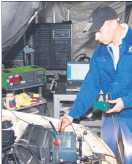
Roman Seppenen tutkii diagnostiikkalaitteella Volvon lambda-anturia.
