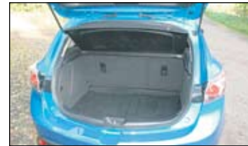
Takapenkin selkänokat kaatuvat kahdessa erisuuruudessa osassa mahdollistaen pitkänkin esineen kuljettamisen. Tavaratilan tilavuus normaalisennossa on 340 litraa.
