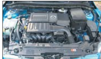
Moottorina koeajetussa Mazda kolmosessa on 1,6 litrainen alumiinirakenteinen bensiinimoottori, joka kehittää 77 KW:n tehon ja 145 Nm:n väännön. Hiilidioksiidipäästö on 149 g/km.
