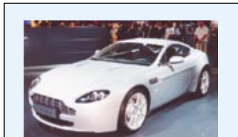
2-paikkaisen, liimatun alumiinirungolle tehdyn Aston Martinin paino on 1570 kg. Moottori vapaasti hengittävä 4,3-litrainen ja 380 hv V8. Auto oli näyttelyssä lähellä Jaguaria. Minä ottaisin Aston Martinin!
