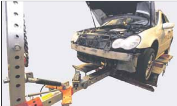
Autorobot-korinoikaisulaitteella työ onnistuu vaikeimmissakin kolaritapauksissa.
