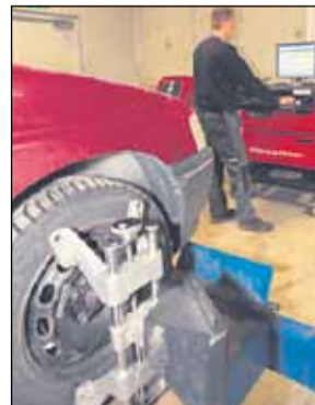
Nelipyöräsuuntaus ajanmukaista laitteistoa käyttäen.
