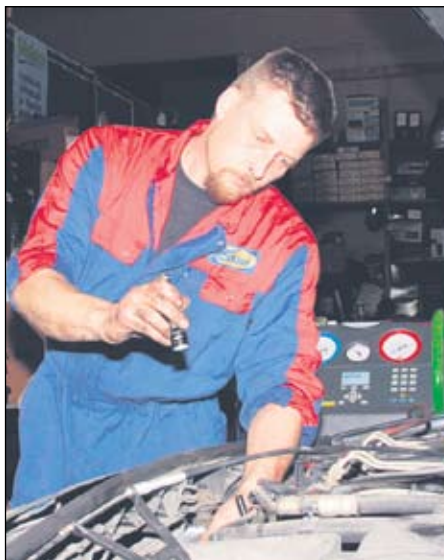
Asentaja Jorma Halonen täyttää Ford Mondeon ilmastointijärjestelmää.
