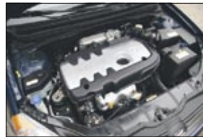
Uuden Accentin 1,6 litraisessa moottorissa on 16 venttiiliä, kaksi nokka-akselia ja muuttuva venttiilien ajoitus.
