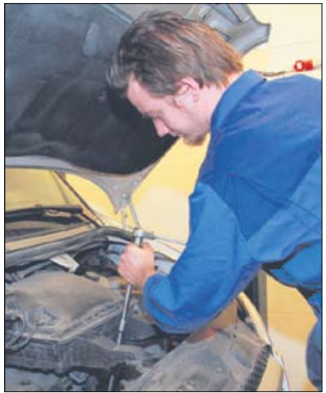
Asentaja Ville Hyytiäinen vaihtaa Mercedes-Benz -pakettiauton öljynpuhdistinta.
