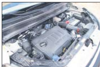
Koeajoautossa on 1,6-litrainen yhteispaineruiskutuksella varustettu 16-venttiilinen dieselmoottori, joka tuottaa 94 kW:n tehon ja 260 Nm:n väännön laajalla käyntinopeusalueella.
