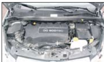
Corsan 1,3-litrainen dieselmootori kehittää 55 kW:n tehon ja vääntöä 170 Nm. Hiilidioksidipäästö on 109 g/km ja yhdistetty polttoaineen kulutus 4,1 l/100 km.
