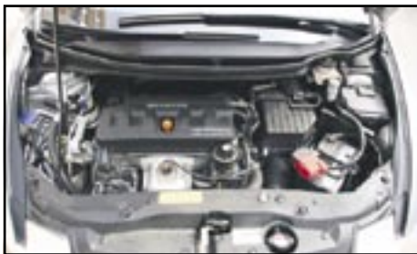
Moottorivaihtoehtoja on kolme alkaen 1,4 litran bensiinimoottorista. Koeajoauton 1,8 VTEC-moottori kehittää 103 kW tehon.
