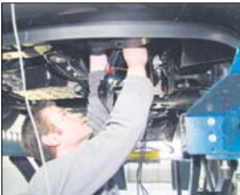
Mekaanikko Jussi Ahonen asentaa Webasto-lämmitintä tila-autoon.
