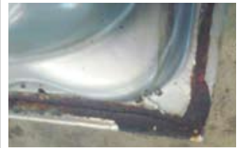
Kuva 2. Samanlainen auto vuosimallia 2003. Auton oven kulman kitattu sauma.
