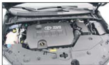
Moottorina koeajetussa Avensiksessa on 1,6-litrainen Valvematic-bensiinimoottori, joka kehittää 97 kW:n tehon ja vääntöä 160 Nm.
