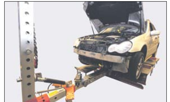
Autorobot-korinoikaisulaitteella työ onnistuu vaikeimmissakin kolaritapauksissa.
