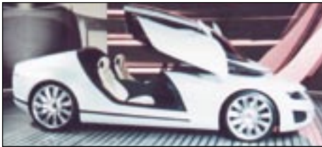
Saabin konseptiauto AeroX oli eräs näyttelyn vetonauloista. Muotoilussa palataan merkin juurille - Saabhan tarkoittaa Svenska Aeroplan Aktie Bolaget (Ruotsin Lentokone Osake Yhtiö)! 400 hevosvoiman tuplaturbolla varustettu V6- kone käy bioetanolilla.
