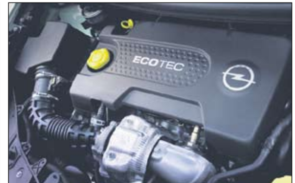
Uudistuneeseen Opel Corsaan on valittavissa 1,3 CDTi turbodiesel. Tehoa 70 kW (95 hv) ja suurin 190 Nm:n vääntö on käytettävissä laajalla käyntinopeusalueella 1750 - 3250 r/min
