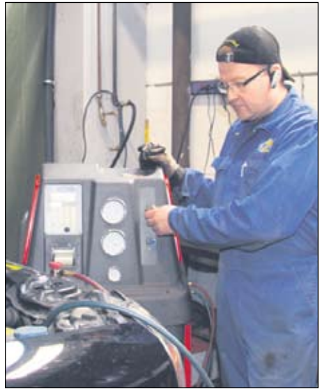
Petri Julin on kytkenyt ilmastoinnin huoltolaitteen citymaasturiin.
