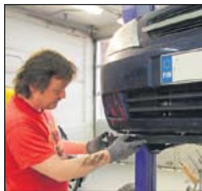
Muovilistan kiinnitys auton puskuriin.
