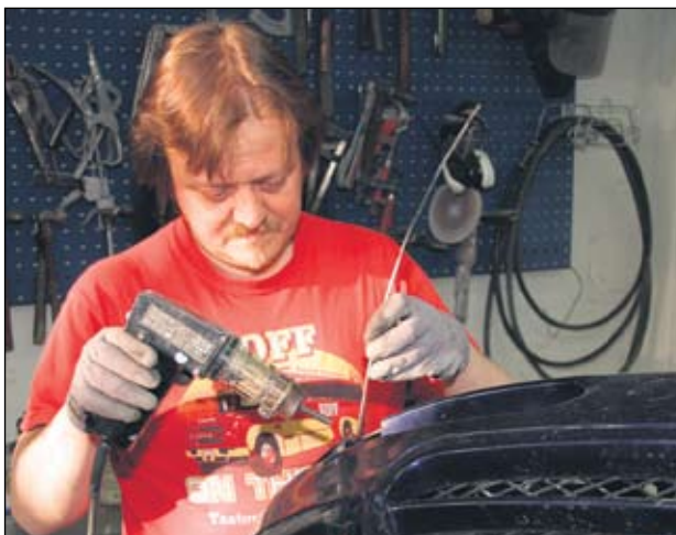
Muovimestari Jyrki Pelkonen hitsaa auton puskuria.
