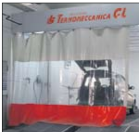
Uusi valoisa kattoimurilla varustettu maalauskoppi.
