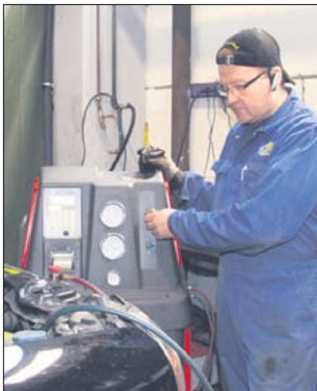
Petri Julin on kytkenyt ilmastoinnin huoltolaitteen citymaasturiin.
