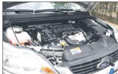
Koeajoautossa on Focuksen kolmesta turbodieselmoottorista pienin eli 1,6-litrainen, PSA-konsernin kanssa yhteistyönä syntynyt alumiinimoottori.
