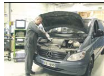
Asentaja Petri Saarela on kytkenyt Mercedesksen testeriin. Imuilman saannissako on häiriöitä?
