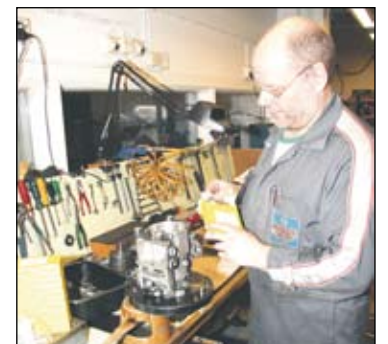
Opel Vectran pumppu korjausvaiheessa. Boschin uusia osia asentaa Petri Saarela.
