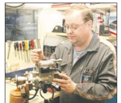
Asentaja Timo Suuronen on saamassa Hyundaiin EDC sähköisesti ohjattua jakajamallista pumppua kuntoon. Tämä ZEXELn valmistama pumppu on hyvin yleinen korealais- ja japanilaismerkeissä. Bosch omistaa ko. pumpputehtaan Japanissa. Ekström Servicen Bosch Diesel Center on ainoa Suomessa, joka pystyy korjaamaan ja testaamaan ZEXEL-pumppuja.
