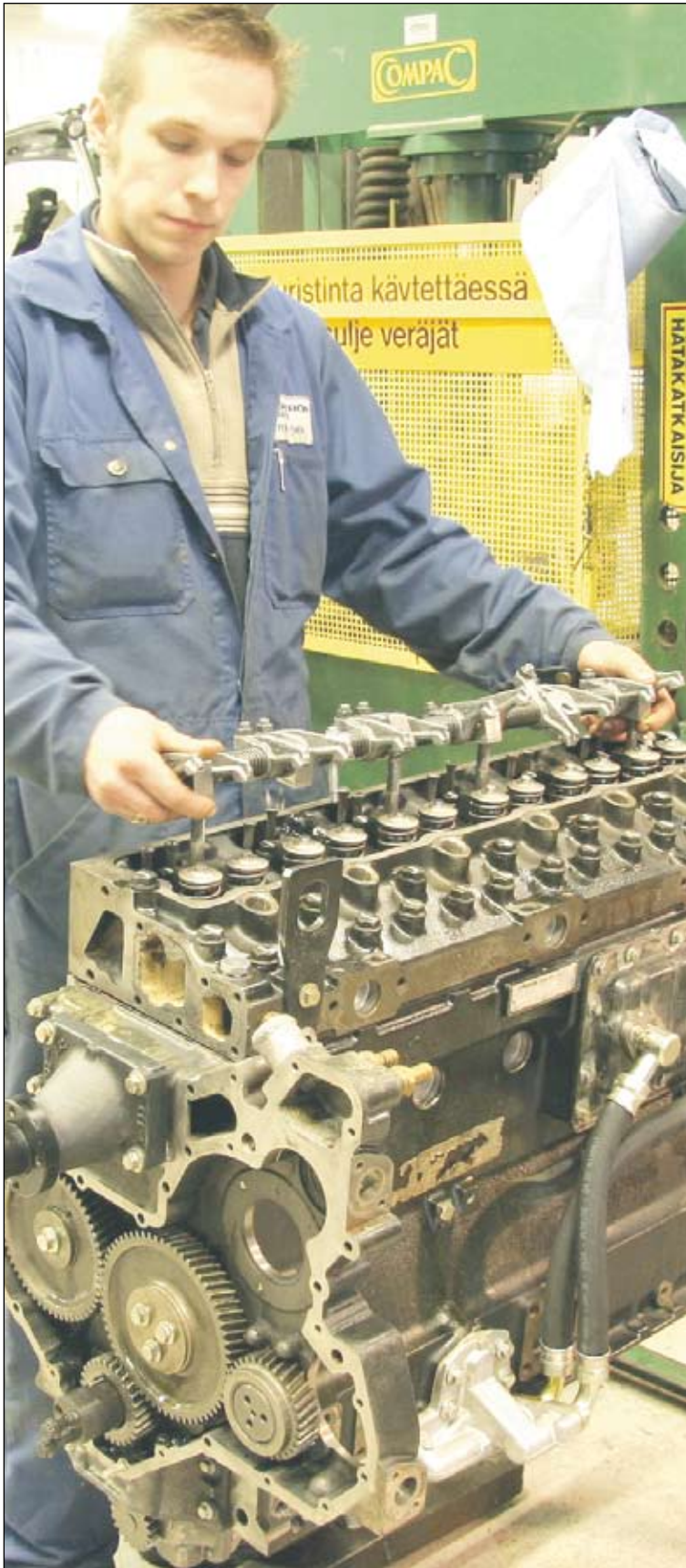
Täydellisen korjauksen läpikäynyt metsäkoneen Perkins-dieselmoottori kokoamisen loppuvaiheessa. Venttiilikoneiston keinuvipuja sovittaa asentaja Perttu Örn.
