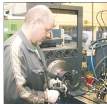
Mitkä mahtavatkaan olla Fiat Ducaton common rail CPI-pumpun aivot? Asentaja Petri Saarela on asentamassa pumppua koetukselle. Testauksen aikana paineet ovat niin korkeat, että tapahtumaa on seurattava kaksinkertaisten turvalasien takaa.
