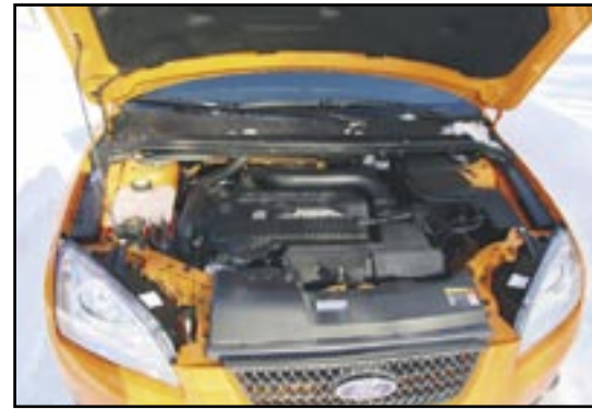
Ford Focus ST:ssä on 5-sylinterinen ahdettu 2,5-litrainen moottori, jonka teho on 166 kW (225 hv). Vääntöä on 320 Nm.
