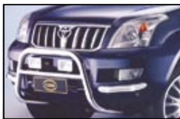
Lisävalot on helppo kiinnittää "karjapuskurin" valmiisiin kiinnityskohtiin.
