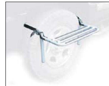
Kuormauksen ajaksi renkaan päälle asennettava Step Up -astinkoroke.
