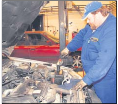
Volvo V40 määräaikaishuollossa. Jukka-Pekka Kivimäki täyttää akkua akkunesteellä.
