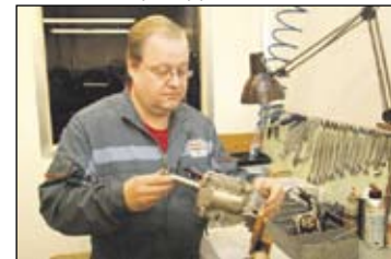
Timolla työn alla Zexel'in elektronisesti ohjattu jakajapumppu.
