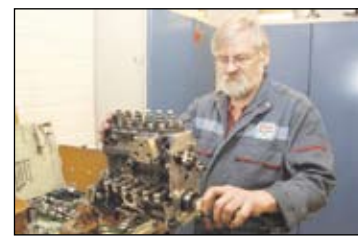
Mikko peruskunnostamassa raskaan kaluston rivipumppua.
