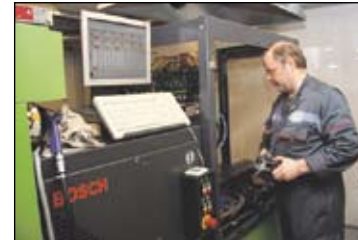
Petri koeajamassa yhteispaine (Common Rail) korkeapainepumppua.
