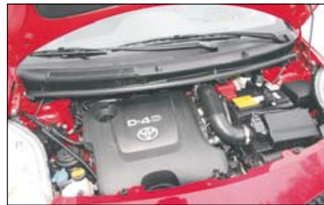
Koeajetussa Yaris 1,4 D4D -mallissa on 1,4-litrainen alumiininen 8-venttiilinen diesel.
