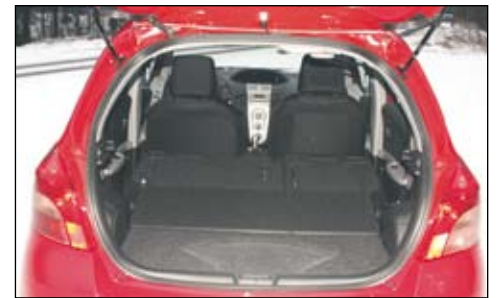
Tavaratilan koko on 363 litraa ja tilaa voi kasvattaa selkänojat kaatamalla peräti 737 litraan.
