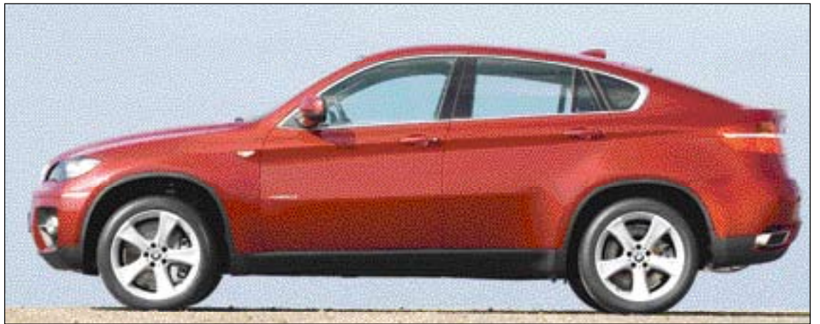
Uudessa BMW X6:ssa BMW:n uusi Dynamic Performance Control parantaa hallittavuutta. Vetäville pyörille siirrettävä voima jakautuu optimaalisesti pyörien kesken.
